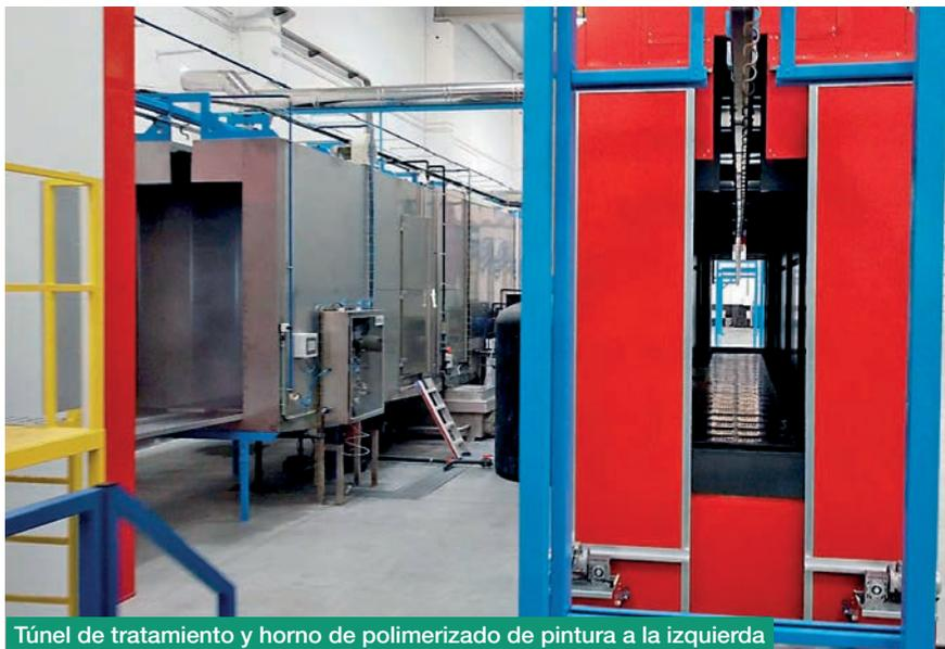
Túnel de tratamiento y horno de polimerizado de pintura a la izquierda
