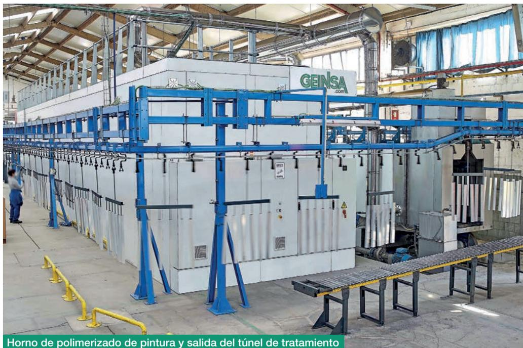
Horno de polimerizado de pintura y salida del túnel de tratamiento
